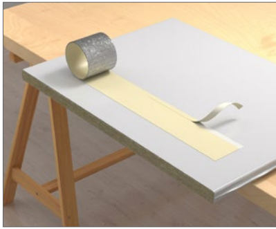
2. Ajustez le ruban le long du bord en marquant 10 mm de débord, puis décollez les 10 mm de papier de l'adhésif.
